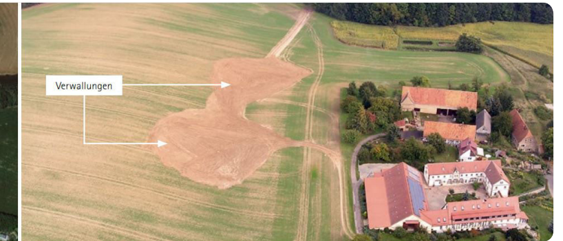
Abb. 63: Gebiet des Pilotprojektes in Pröda, OT Nossen, nach dem Eingriff. Die obere Verwallung hat ein Speichervolumen von 500 m³, die untere ein Speichervolumen von 200 m³ (LfULG, Peschke 2012).
