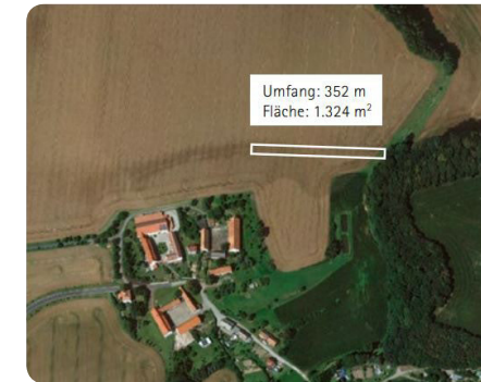
Abb. 62: Gebiet des Pilotprojektes in Pröda, OT Nossen vor dem Eingriff. Die erosive Abflussbahn ist 500 m lang, hat eine Neigung von >8% und ein 6 ha großes Einzugsgebiet (LfULG, Peschke 2012).
