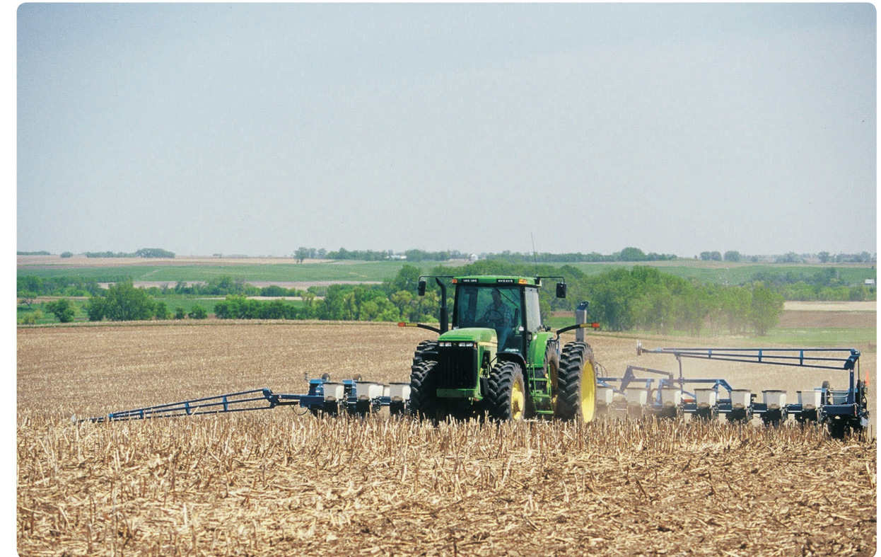
Abb. 53: Direktsaat ohne Pflug, mit Direktsaatmaschine (Artix Kreiger, CC BY-SA 2.0).
