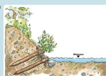
Schematische Darstellung Krainerwand mit einer Entwicklung nachster Monate (WWU o. J. 7, Abb. 4.32)
